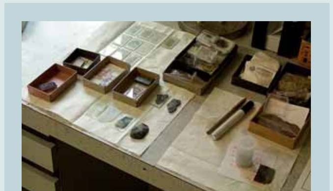
DÜNNSCHLIFF EINES GESTEINS Drei Hundertstel Millimeter dick sind die Dünnschliffe, die die Präparatoren herstellen. Das Gestein ist nun durchsichtig. Im Mikroskop (10fache Vergrößerung, gekreuzte Polfilter) lassen sich die Gemengteile des Gesteins – hier: Olivin aus Erdmantelgestein, Oman – genau bestimmen.
